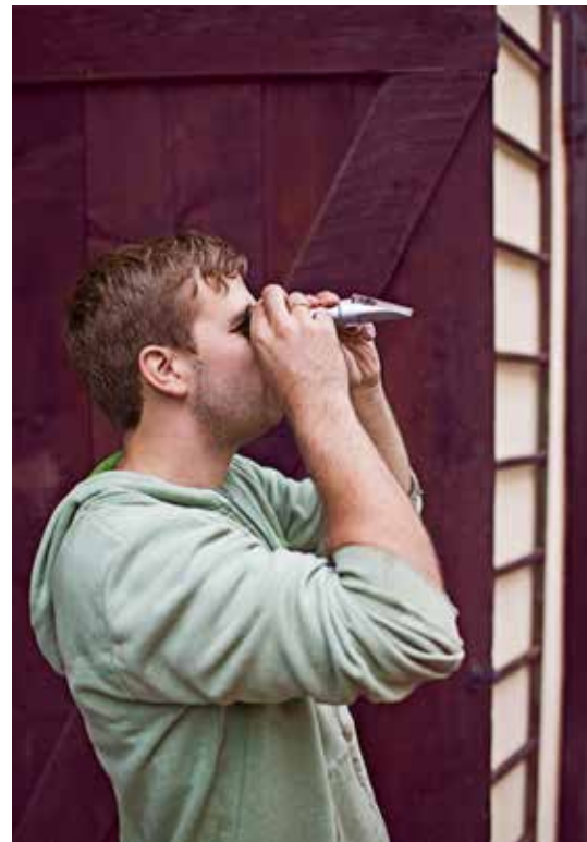
Mostgewicht messen mit dem Refraktometer
